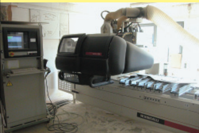
Vielseitiges Herzstück der Fertigung ist das 4-Achs-Bearbeitungszentrum Author 500 S von Morbidelli
